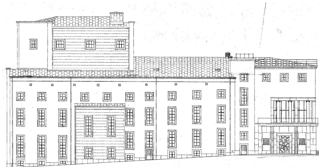
FASAD MOT NORDVÄST. SALONGSHUSET MED DET HÖGRE OCH NÅGOT INDRAGNA SCENHUSET TILL VÄNSTER I BILD. TILL HÖGER FOYERHUSET. NYBYGGNADSRITNING (FÖRÄNDRINGSRITNING) 1932. KÄLLA: GÖTEBORGS STADSBYGGNADSKONTORS ARKIV
