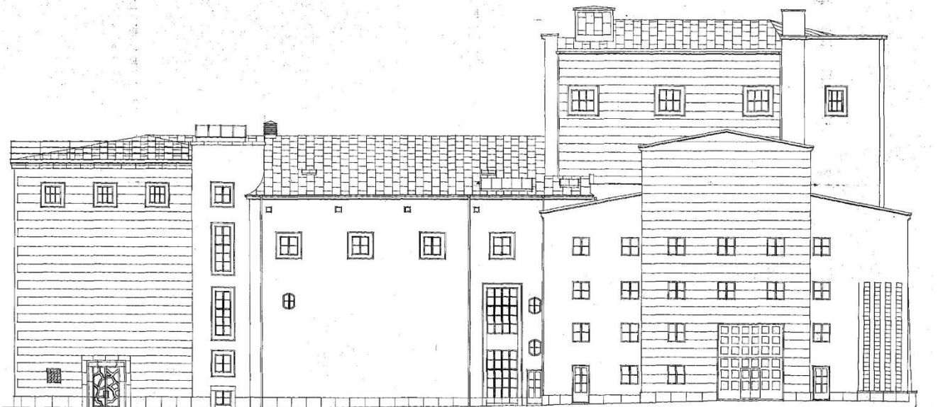
FASAD MOT SYDÖST. FOYERHUSET TILL VÄNSTER I BILD, GAVELN PÅ MAGASIN OCH- VERKSTADSHUSET TILL HÖGER OCH BAKOM DET SCENHUSET. SALONGSHUSET I MITTEN. NYBYGGNADSRITNING 1931. KÄLLA: GÖTEBORGS STADSBYGGNADSKONTORS ARKIV
